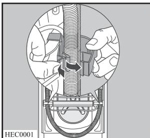
3. При помощи специального гаечного ключа отвинтите и удалите центральный задний болт А. Извлеките соответствующую пластиковую вставку.
