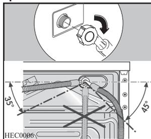
3. Правильно расположите шланг, ослабив круглую гайку. Расположив должным образом наливной шланг, вновь затяните круглую гайку для предотвращения течей.
